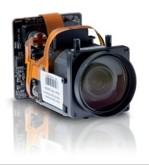
Сетевая Full HD модульная видеокамера с 20-ти кратным оптическим увеличением
