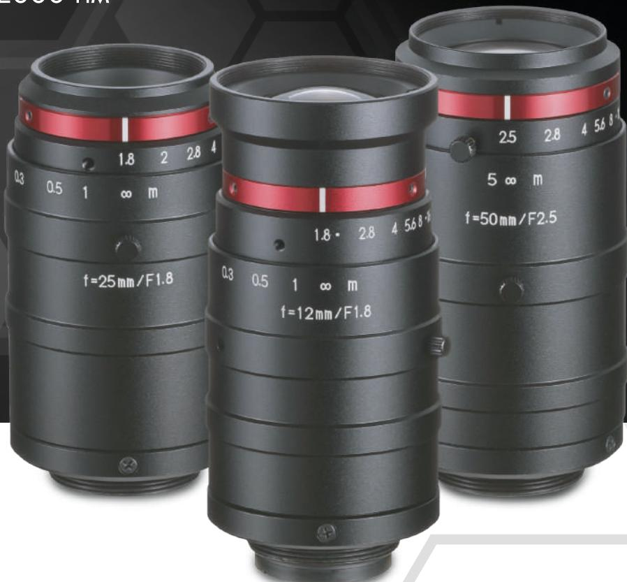
Серия объективов Kowa HC-VIS-SW позволяет производить инспекцию объектов в широком диапазоне длин волн от видимой до коротковолновой инфракрасной области спектра (Short Wavelength Infrared Range – SWIR). Благодаря использованию в объективах линз с ИК-коррекцией, не происходит сдвига фокуса при изменении длины волны с видимой на инфракрасную или наоборот.
